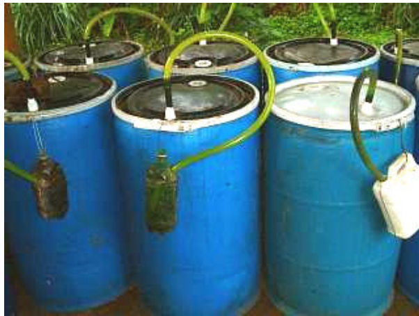
Foto 1: Tanques biofermentadores con válvulas de escape de gases.
